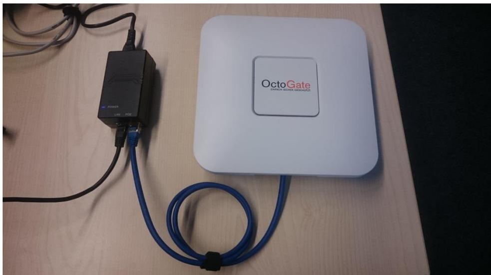
Im zweiten Schritt wird der Switch mit dem WLAN-Port der OctoGate Firewall verbunden.
