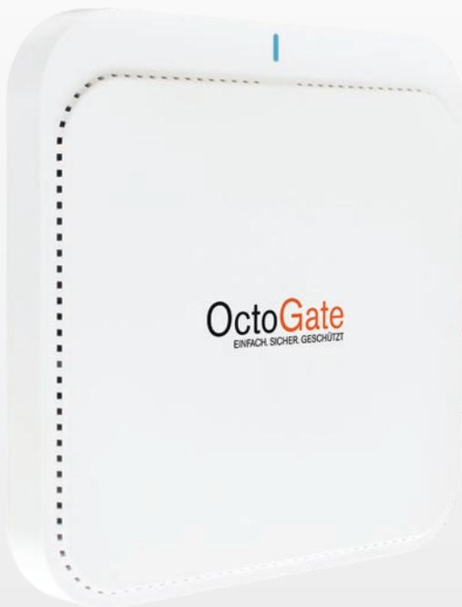
Die Lösung für ein modernes, leistungsstarkes und sicheres WLAN Netz für Ihr Unternehmen. Das AX-3500 Modell ist für Einrichtungen mit mittleren bis großen Bandbreitenanforderungen konzipiert worden. Basierend auf dem neuesten WLAN Standard (Wi-Fi 6) stehen Ihnen noch leistungsstärkere Geräte zur Verfügung als jemals zuvor.
