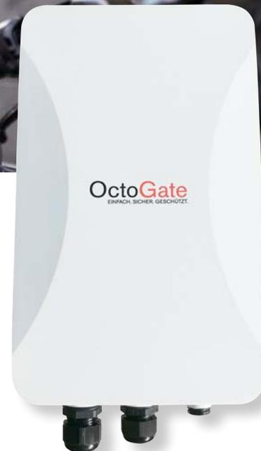
Der **Outdoor AX-Access Point** kann schnell und einfach installiert und in das vorhandene Netz integriert werden. Wichtige Außenbereiche wie die Innenstadt, Sport- oder Parkplätze werden somit unkompliziert mit WLAN ausgestattet. Die vier außenliegenden 6 dBi Dual Band omni Antennen erreichen eine **Abdeckung von bis zu 400 Metern Entfernung**. Einmal mit dem internen Netz verbunden, verbinden sich die Access Point automatisch auch mit der optional erhältlichen OctoGate Firewall.
