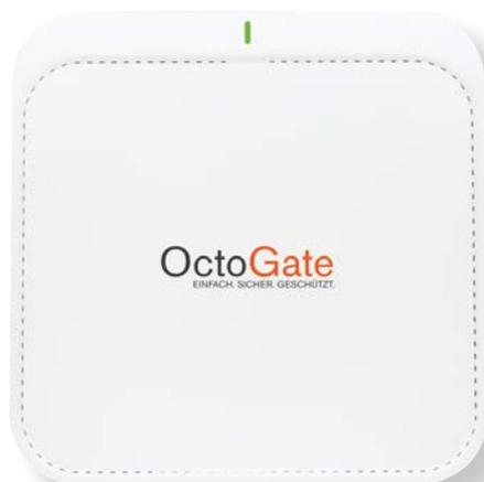
Mit dem **AX-Access Point** können Sie auf eine komplizierte Verkabelung verzichten. Er verfügt über 2 Netzwerkanschlüsse, die als Switch konfiguriert werden können. Einer davon unterstützt neben PoE auch den neuen 2.5 Gbit/s Standard. Server, PCs und Access Points können so **schnell und einfach miteinander verbunden** werden. Einmal mit dem internen Netz verbunden, verbinden sich die Access Points automatisch auch mit der optional erhältlichen OctoGate Firewall.
