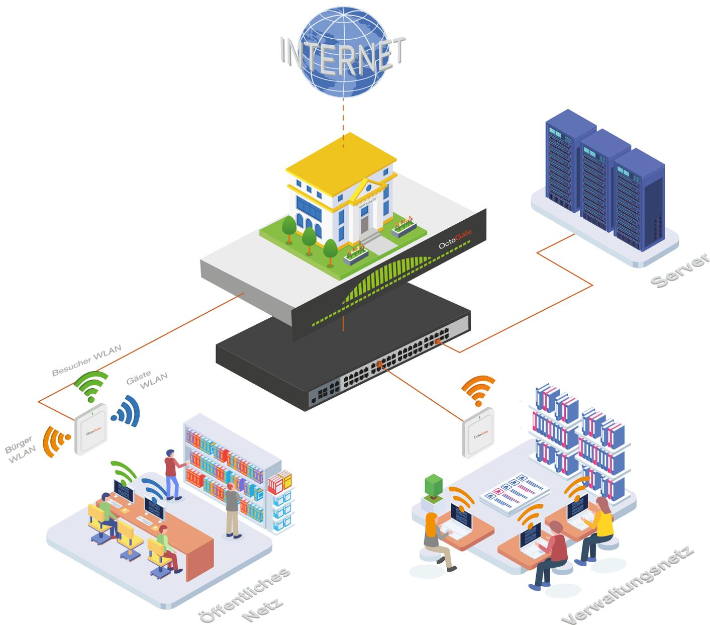
Die Abbildung zeigt das Beispiel eines Rathauses mit installierter **OctoGate Firewall**. Diese sitzt zentral zwischen physikalisch getrennten Netzen und kontrolliert sämtlichen Datenverkehr. Dadurch ist eine Koexistenz von öffentlichen Netzwerken, dem Verwaltungsnetzwerk und sensiblen Netzen für z. B. Server datenschutzrechtlich möglich. Alle **Access Points** werden zentral von der Firewall gesteuert,
