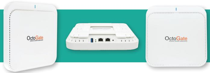
Die Lösung für ein modernes, leistungsstarkes und sicheres WLAN Netz an Ihrer Schule. Das AX-3000 Modell ist für Bildungseinrichtungen mit geringen und mittleren Bandbreitenanforderungen konzipiert worden. Basierend auf dem Wi-Fi 6 WLAN-Standard stehen Ihnen noch leistungstärkere Geräte zur Verfügung als jemals zuvor.
